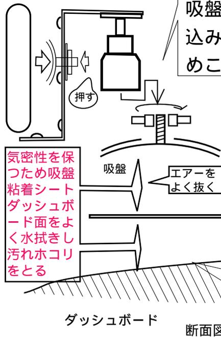
吸盤を下に押しつけてロックを締め
