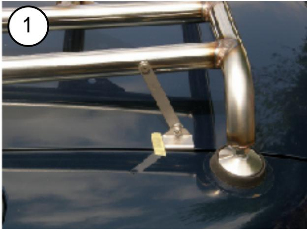
トランクを開けて、リンケージブラケットをトランクに仮固定し、リンケージ板でトランクキャリアとリンケージブラケットを連結し、マスキングテープ等で取付け位置をマーキングする。
