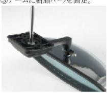
④先に外した純正のネジでルーフに固定。
