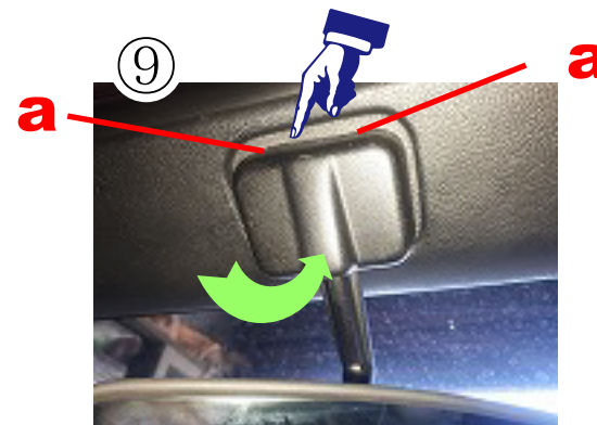
⑨ “a”部の内爪を先に引っ掛け 緑の矢印へ押込み 純正カバーを装着します。
