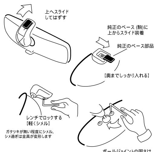
ボールジョイントの固さは 2箇所のネジを締めて調整
