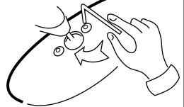
ボールジョイントの固さは2箇所のネジを締めて調整
