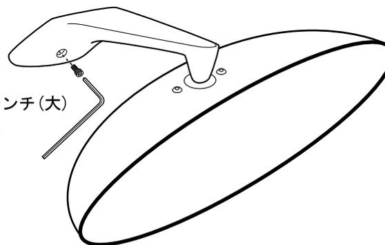
※ミラー回転の固さは、上面2本のビスを付属のレンチで回して調整します。
