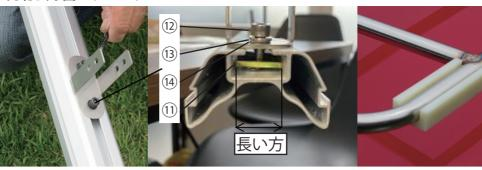
①をサイクルキャリアに仮組みします。EC21SA、EC29は①②③④も使いますが①の長い方をこの向きにします(短い方だと長方形ナットが抜けて危険)
