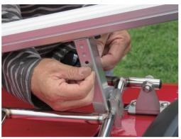
①②を仮組みします。⑤⑩は必ず 2組み使用してください。延長ア ームが変形するので締めすぎ注意
