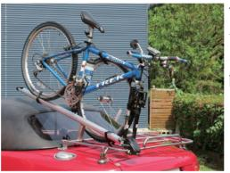
市販のサイクルキャリアのマニュアル(画像はTERZO(テルッオ)製 EC21)に従い、自転車を積みます。またフロントタイヤは車内に積むか画像のように強度のあるバンド等を3本位使用し固定します。
