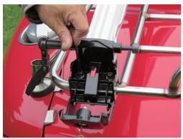
④を間に挟み込みサイクルキャリアをトランクキャリアに仮組みします。
