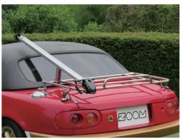
全体のレイアウトが決まりました ら仮組みしたボルト、ナット類を 本締めします。
