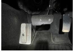
注意 ペダルが水平になるようにする ∕∱ 両面テープがつく面を良く脱脂する
