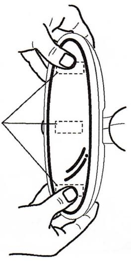
③“ブルーワイドルームミラー”の両面テープ部分を軽く押し付け、しばらく圧着をしながら、しっかりと固定して下さい。両面テープ部以外を押し出すとミラーが割れる恐れがありますので、注意して下さい。両面テープは屋外用を目的とした強力タイプですが、初期接着性が弱い傾向があります。装着後、24時間程度はスレ・剥がれ落ち等に十分注意して下さい。また走行前に両面テープの接着がしっかりとれているかどうか、よく点検して使用して下さい。
