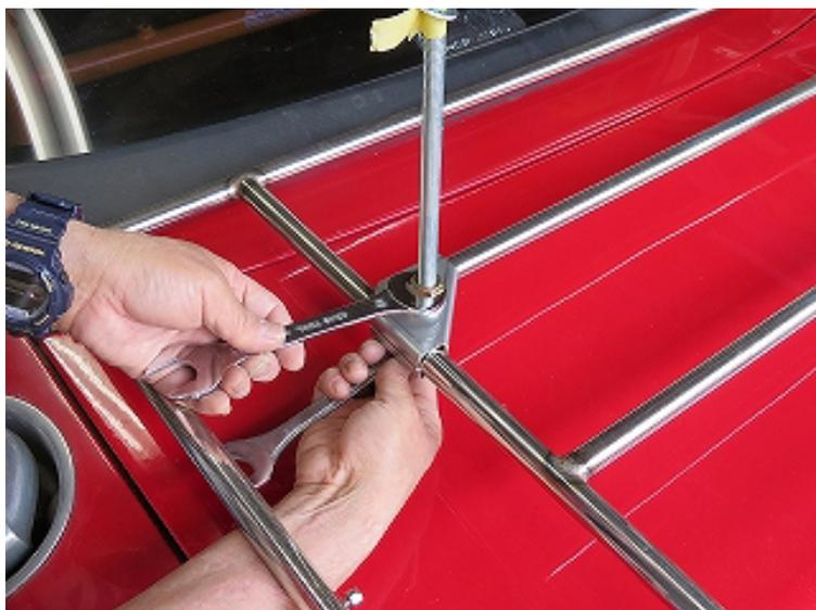
19のレンチを使用し④を締めて①を固定します。
