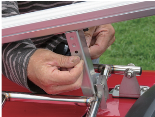
①②を仮組みします。⑤⑩は必ず2組み使用してください。延長アームが変形するので締めすぎ注意
