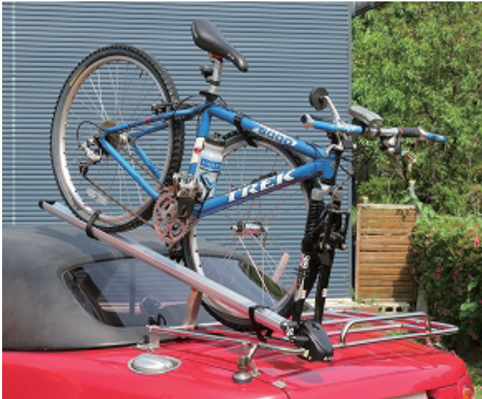
①②を仮組みします。⑤⑩は必ず2組み使用してください。延長アームが変形するので締めすぎ注意
