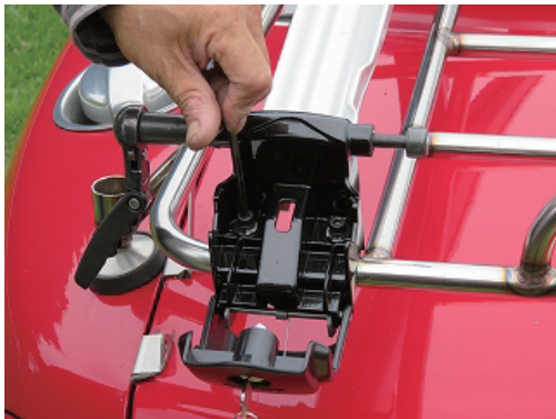
④を間に挟み込みサイクルキャリアをトランクキャリアに仮組みします。
