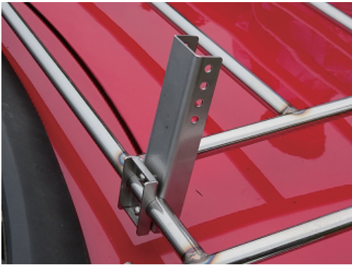
②③をトランクキャリアに仮組みします。
