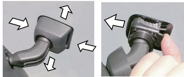
※ミラー回転の固さは、上面2本のビスを付属のレンチで回して調整します。
