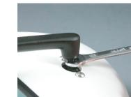
アームを外す場合は、8mmのスパナでナットを押さえアームを左に回転させる様に外します。
